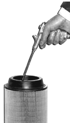
Рис. 6.3 Очистка фильтрующего элемента воздушного фильтра
