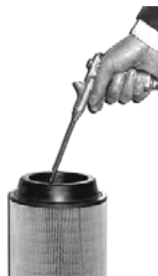
Рис. 11.3 Очистка фильтрующего элемента воздушного фильтра
