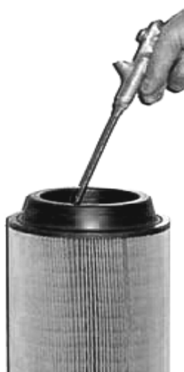
Рис. 6.3 Очистка фильтрующего элемента воздушного фильтра
